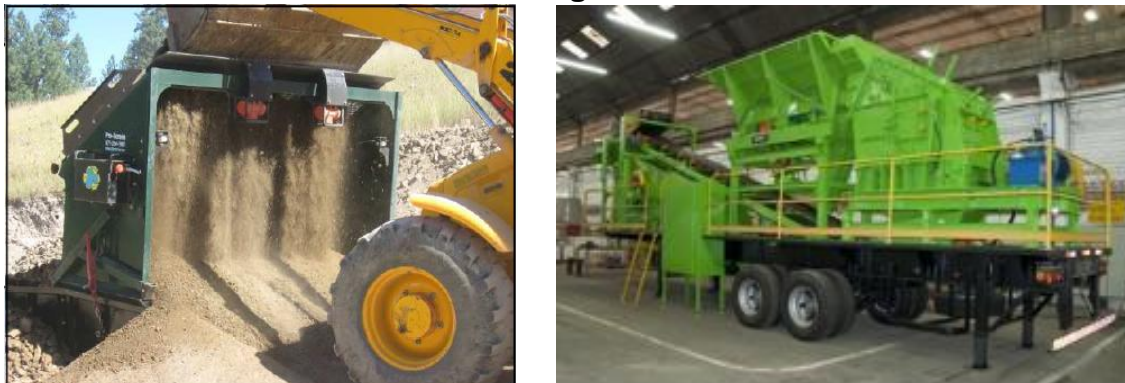
Figura 22 – Equipamentos móveis – peneira vibratória e unidade de reciclagem
